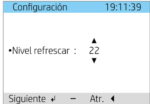
Una vez que se establezca la temperatura preferida, el fresco nocturno estará encendido hasta que la temperatura sea más baja que la establecida, o la temperatura exterior sea más alta que la interior, de esta forma se automatizará durante la temporada cálida.
