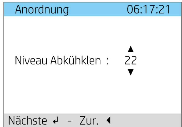
Sobald die Soll-Temperatur eingestellt ist, schaltet sich die Kühlstufe ein, bis die Temperatur unter die eingestellte Temperatur sinkt oder die Außentemperatur über der Innentemperatur liegt, so dass die Einstellung in der warmen Jahreszeit automatisiert wird.
