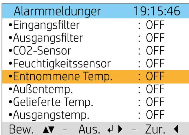
Wenn ein Fehler im Gerät auftritt, leuchten die Anzeigen L4 und L5 auf der Steuertafel auf, und das Display zeigt an, dass ein Alarm ausgelöst wurde. Dazu wird das Symbol „Vorsicht“ angezeigt, und eine Wartung ertönt.
